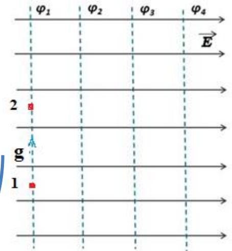
В случае однородного поля эквипотенциальные поверхности представляют собой систему параллельных плоскостей.
