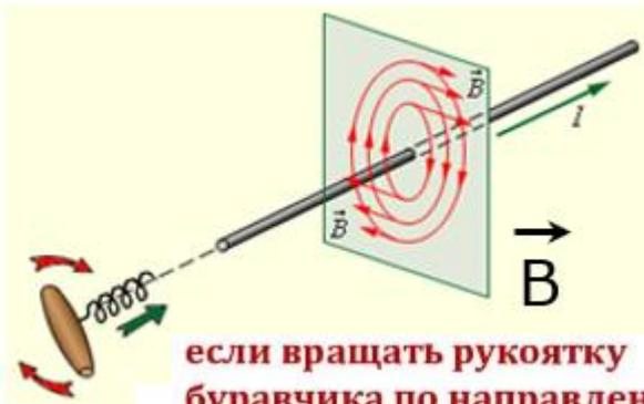
**если вращать рукоятку буравчика по направлению тока в контуре, то поступательное движение винта укажет направление линий индукции внутри контура**
