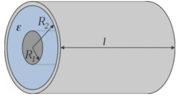
где l - длина конденсатора,  $R_1$  и  $R_2$  - радиусы внутренней и наружной обкладок цилиндрических обкладок.
