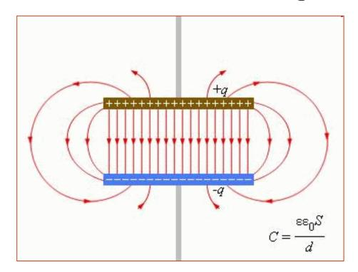
Электрическое поле плоского конденсатора
