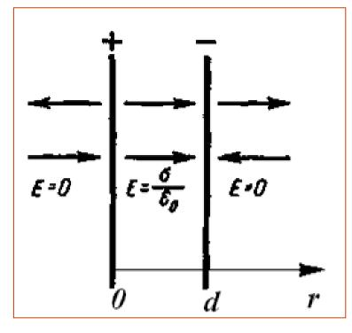
Плоский конденсатор состоит из двух параллельных пластин, разделенных зазором шириной d.
