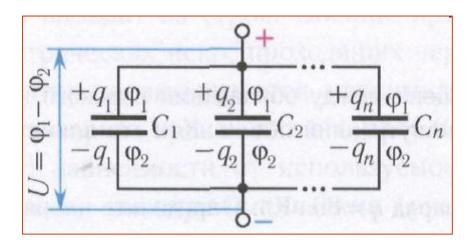
Т.к. соединенные обкладки представляют собой один проводник, то потенциалы всех соединенных в один узел обкладок одинаковы и разность потенциалов между обкладками всех конденсаторов одинакова:  $U_1 = U_2 = U_3 = U$ .
