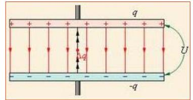
Эта работа идет на создании энергии электрического поля конденсатора:  $CU^2$
