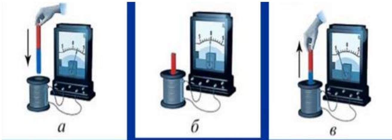
1. **Отклонение стрелки гальванометра** (возникновение индукционного тока) наблюдается *только при относительном движении катушки (соленоида) и магнита.*
