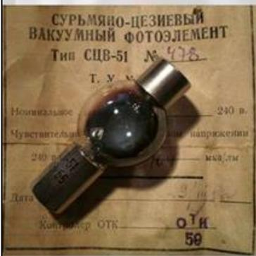
широко применяют в различных схемах автоматики для управления электрическими цепями с помощью световых пучков.
